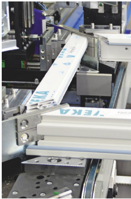
/ Eine gute Verbindung: Alle Profillecken werden auf 250 °C erhitzt und miteinander verschweißt.
