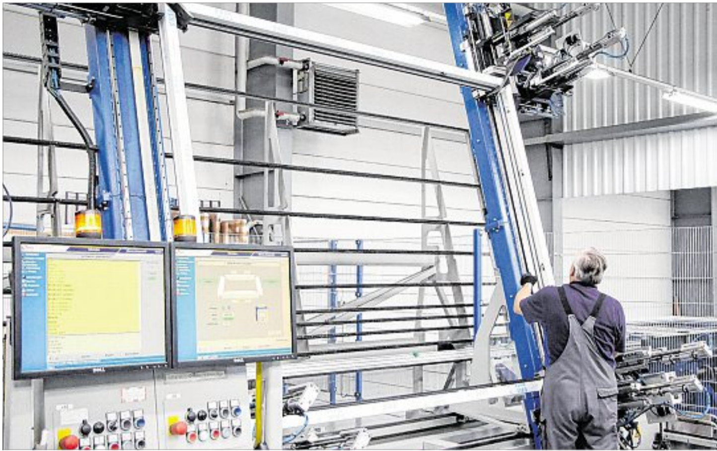
Die Profile aus Kunststoff werden zum Rahmen zusammengeschweißt. Dabei werden die Ecken auf 250 Grad Celsius erhitzt und dann aneinander gepresst. Mehr als 100 000 Fenster und Türen jährlich verlassen die Produktionsstätte. Fotos: Björn Weyand
