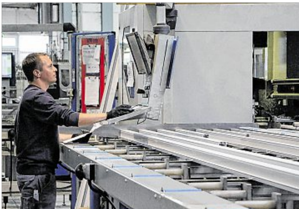
Vom Zuschnitt der Profile bis hin zum Schweißen der Fenster- und Türrahmen läuft die Fertigung komplett papierlos und mit einer hohen Automatisierung ab.
